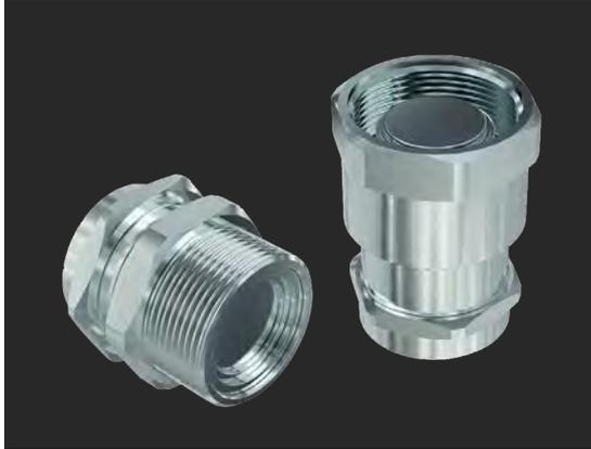
Быстроразъемные фитинги изготовлены из оцинкованной стали и снабжены кольцевой гайкой на шарикоподшипниках. Благодаря этим характеристикам соединительные шланги поставляются частично под давлением, исключая необходимость того, чтобы холодильная техника выполняла процедуру вакуума и заряда на холодильных линиях.
